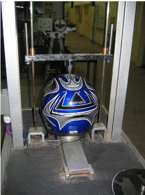
Fig. 6 – Ensayo de penetración
